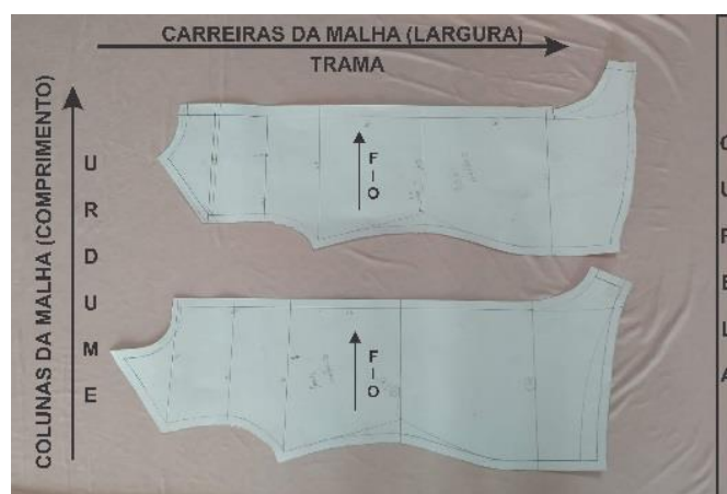
Figura 5. Indicação do fio, da direção da trama e do urdume e posicionamento do molde do collant na malha B
