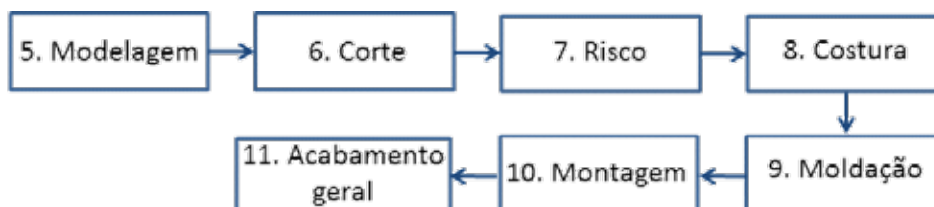
Figura 6 – Processo de fabricação dos tênis – 2ª parte (indústria calçadista)
