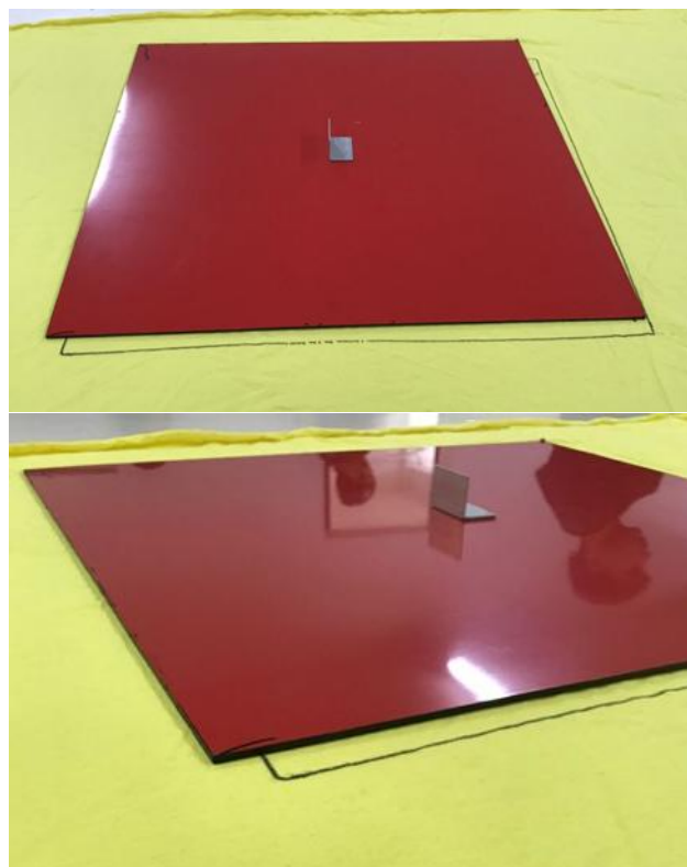
Figura 5: Gabarito utilizado para corte dos corpos-de-prova
