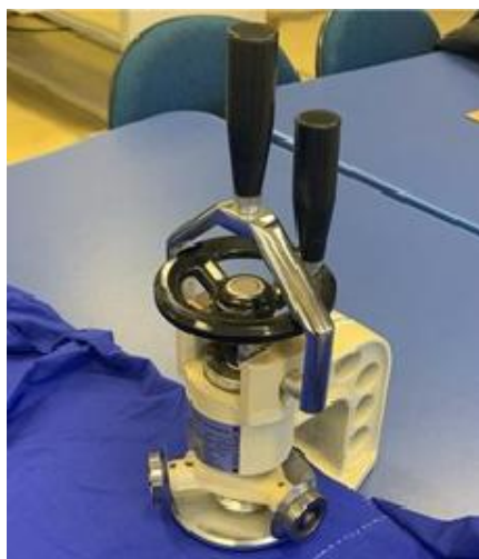
Figura 4: Corte do corpo-de-prova utilizando o cortador circular
