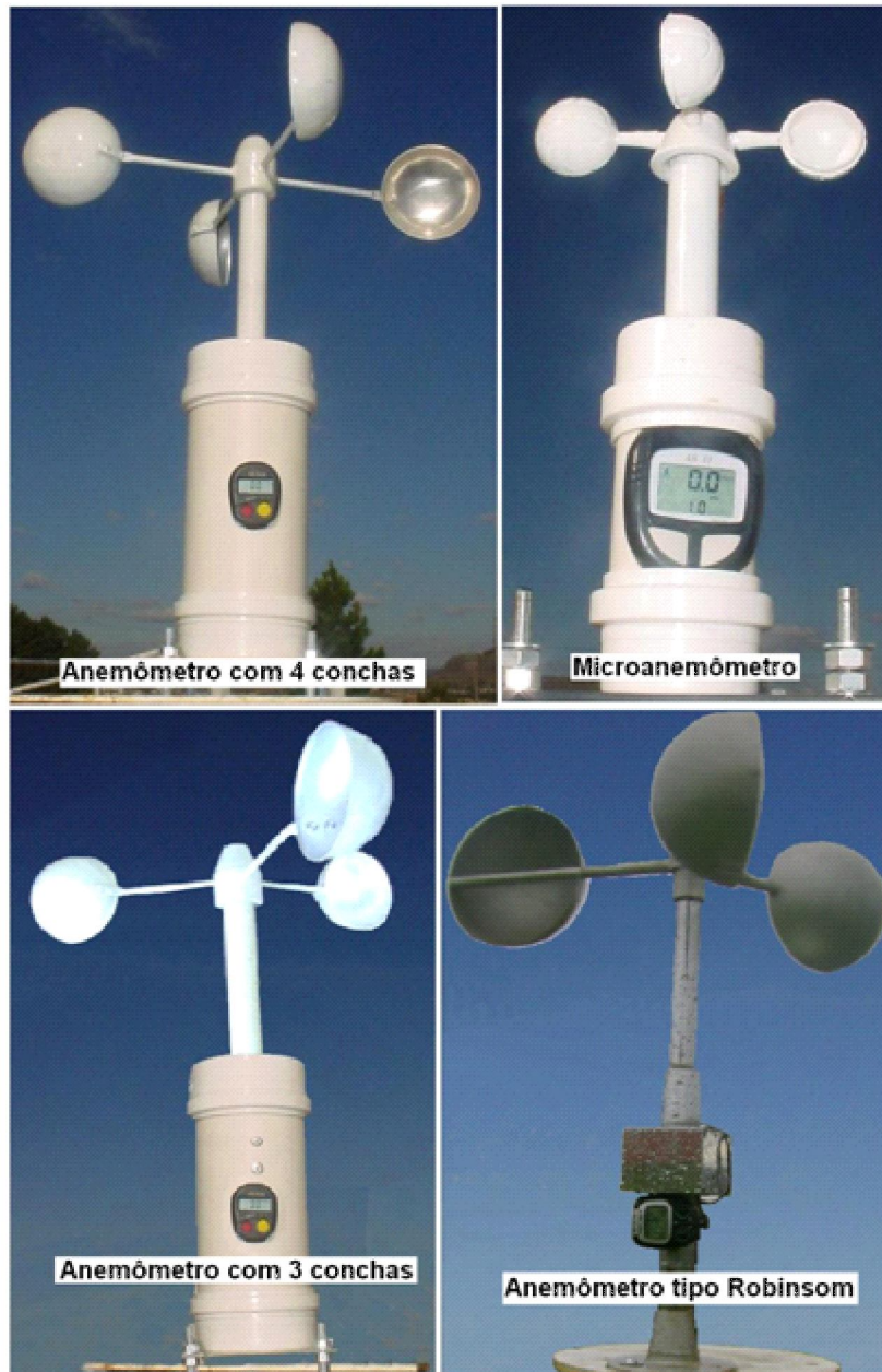
Figura 1 - Anemômetros de baixo custo e anemômetro tipo Robinsom de Fábrica. Centro de Ciências Agroveterinárias - CAV - UDESC. Lages, 2008.
